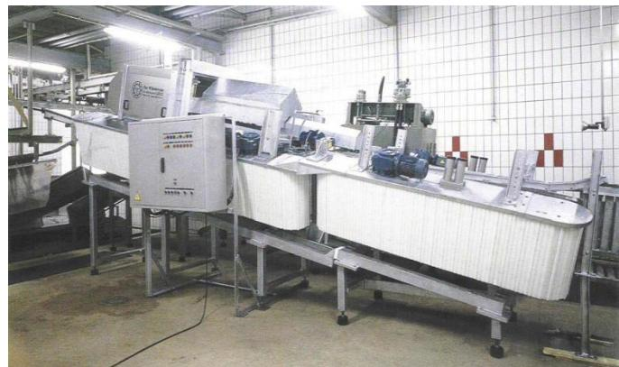
**RESTRAINER:** Tanto manual o automático, está preparado para mataderos con producciones que van desde los 100 c/h, hasta los 250 c/h. Su aturdido es eléctrico, y puede ser mediante pinzas de aturdido (Restrainer manual) o mediante un sistema de aturdido instalado en la propia máquina (Restrainer automático). Este último sistema va destinado para mataderos con altos rendimientos.
