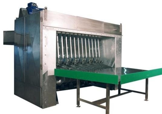
**DEPILADORA CONTINUA:** Máquina peladora de doble eje, con recorrido continuo, se utiliza tras la salida de un escalte vertical y para producciones superiores a los 120 c/h. Su producción puede llegar hasta los 400 c/h dependiendo del número de espirales del eje y el número de máquinas colocadas de forma continua. El arranque de los motores, así como las revoluciones de los mismos van controlados mediante variadores electrónicos de frecuencia
