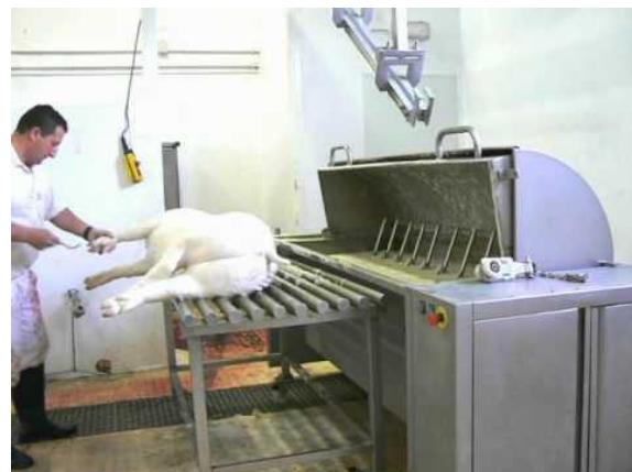
**DEPILADORA HORIZONTAL:** Máquina de un solo eje, perfecta para ir acompañado a escaldes rotativos o por inmersión. Se le puede acoplar tenedor de entrada en el caso de ir en pequeñas balsas de escalte. Para producciones superiores a los 100 c/h con escalte tanto por inmersión o rotativo, se incorporan dos peladoras a distintas alturas.
