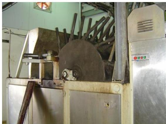
**ESCALDE VERTICAL:** El animal es escaldado mediante agua caliente, pero esta es distribuida a través de unos difusores colocados a lo largo del recorrido en diferentes alturas, con el fin de que los animales sean escaldados homogéneamente a lo largo del tiempo de permanencia dentro de la máquina. Todos los controles y niveles son controlados automáticamente, mediante programadores electrónicos.
