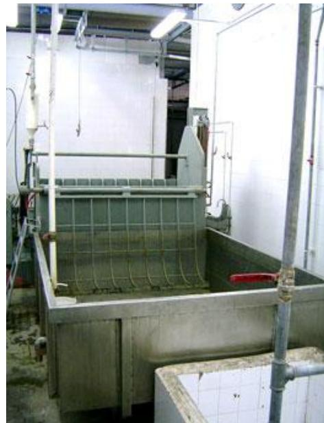
**ESCALDE ROTATIVO:** Consiste en una noria que gira dentro de una balsa de agua. Esta noria está dividida en sectores, en los cuales se depositan los animales ya desangrados. El tiempo es controlado automáticamente, al igual que los niveles de agua y el control de temperatura.
